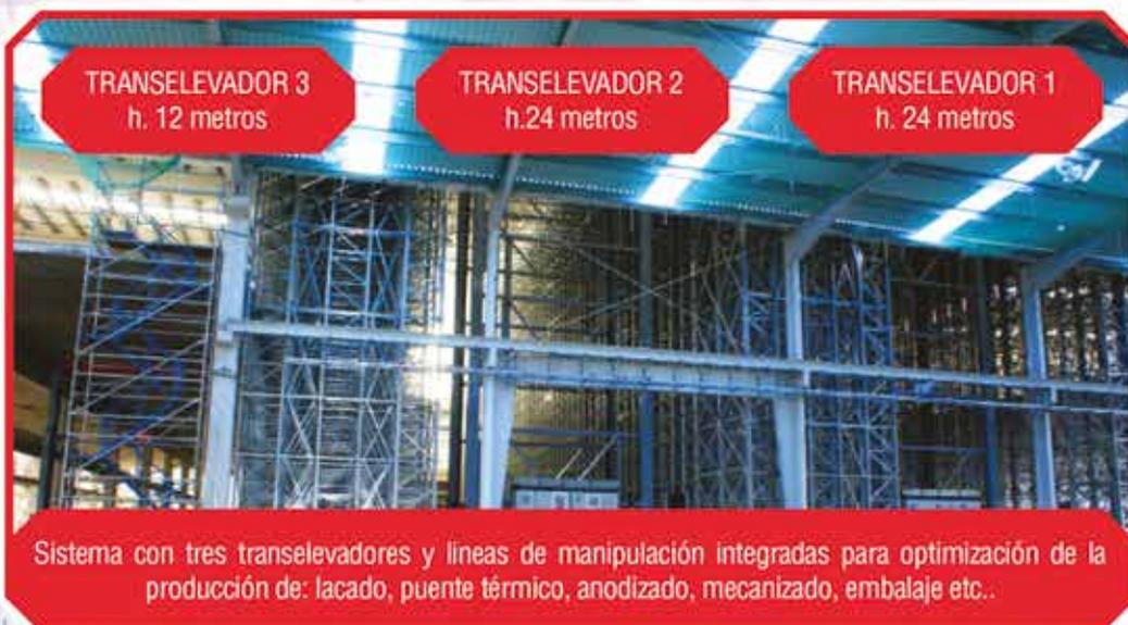
Sistema con tres transelevadores y líneas de manipulación integradas para optimización de la producción de: lacado, puente térmico, anodizado, mecanizado, embalaje etc..
