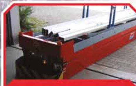
AGV para transporte de contenedores, eskid o cestas para perfiles de aluminio. Los AGV pueden trabajar con estanterías estáticas o interconectarse con almacenes automáticos para alcanzar la máxima automatización.
