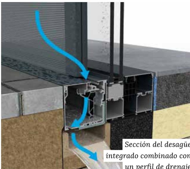
Sección del desagüe integrado combinado con un perfil de drenaje
