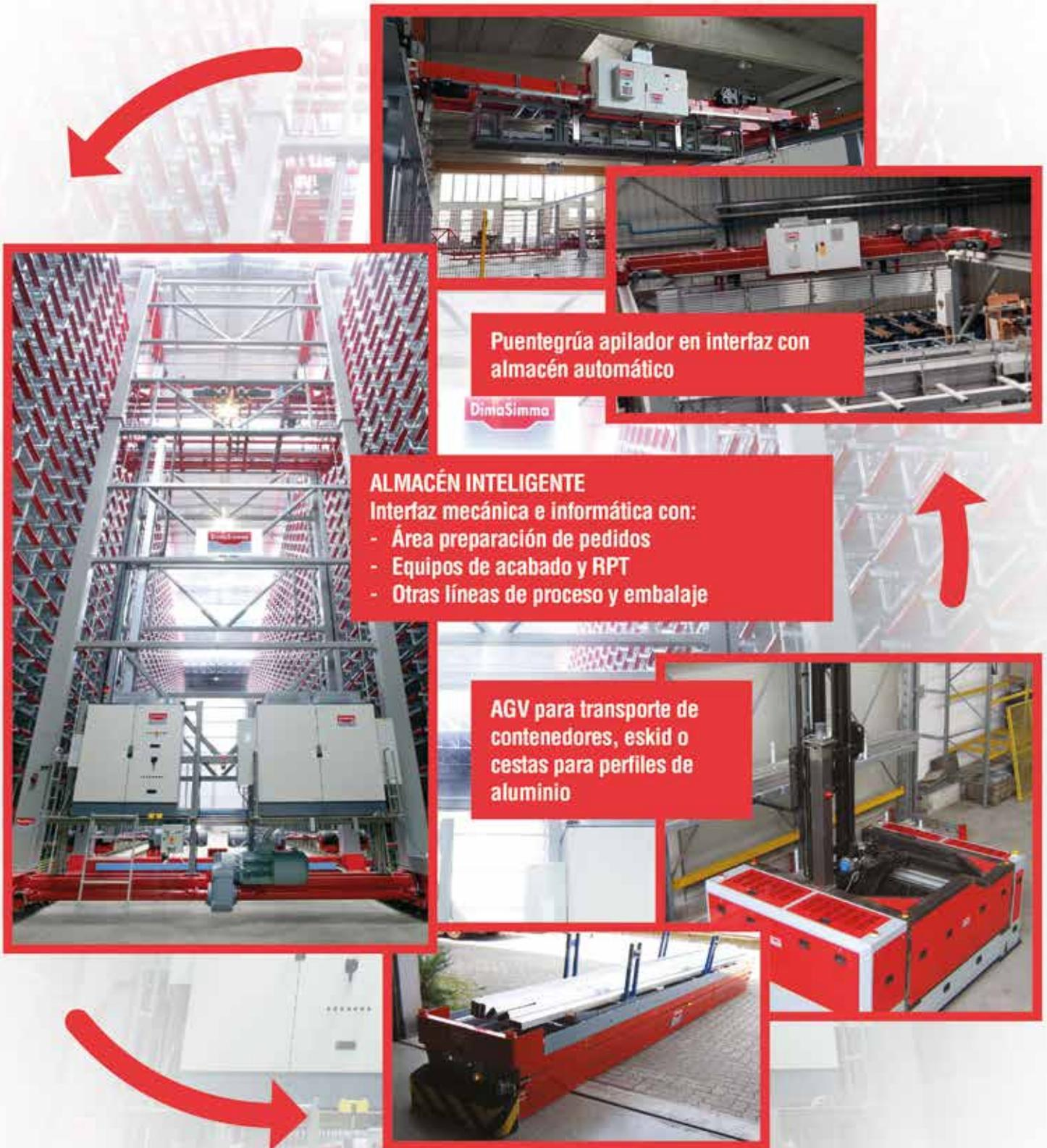
Puentegrúa apilador en interfaz con almacén automático
