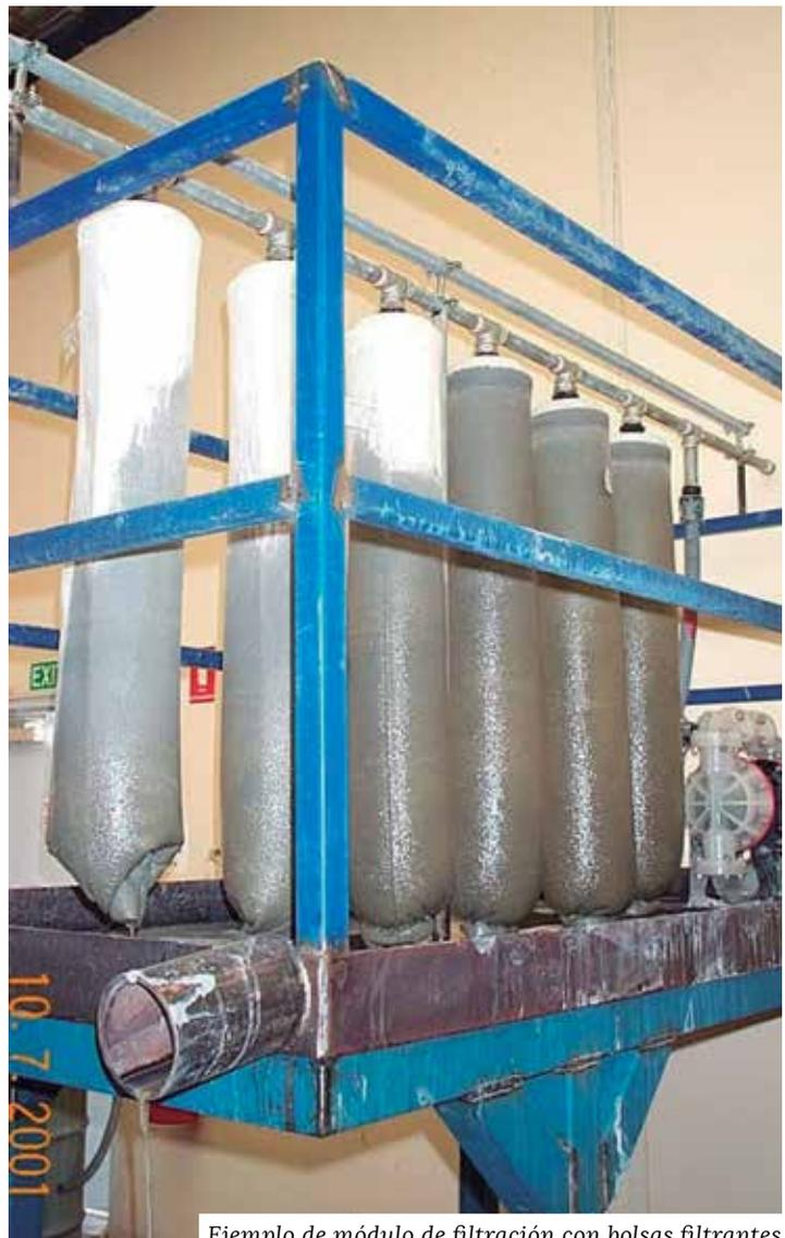
*Ejemplo de módulo de filtración con bolsas filtrantes*
