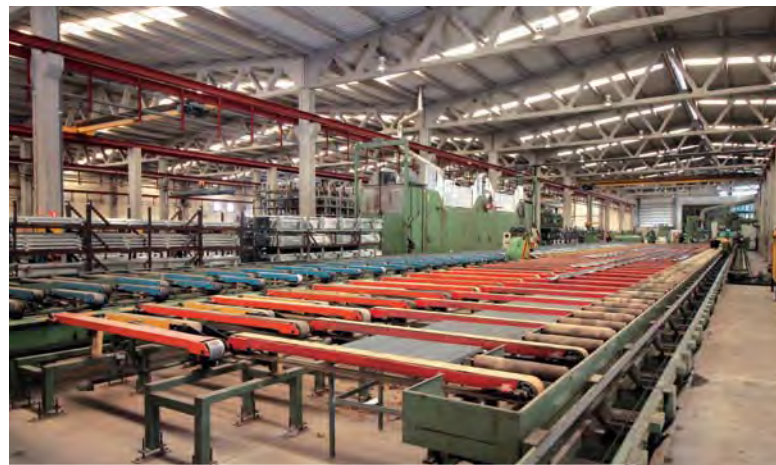
Imagen 4: Los extractores de las dos prensas de extrusión de Aluval, una de 1800 toneladas y otra de 2800.
