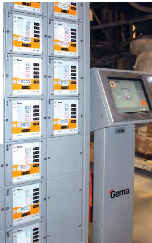
Imagen 9: Los nuevos módulos de control digital permiten regular la electrostática de cada una de las pistolas.
