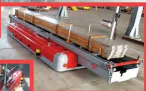
AGV para transporte de contenedores, eskid o cestas para perfiles de aluminio
