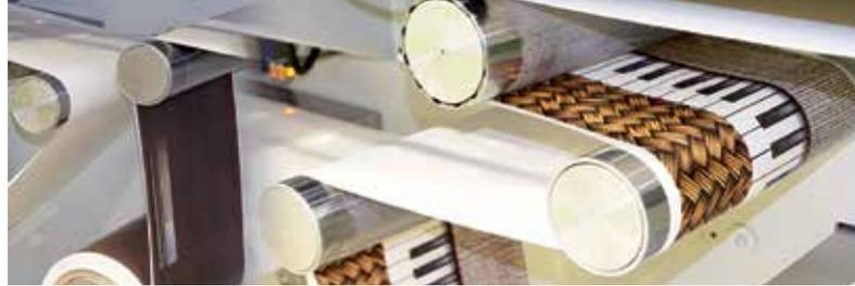
El ancho de impresión de la Jetmaster 350FC es de 50 a 350 mm. La creación del archivo digital para imprimir permite al usuario unir varios diseños en uno para aprovechar el ancho de impresión al máximo. Puede imprimir hasta 5 diseños de 60 mm de ancho con marcas de corte o utilizar el mismo ancho para imprimir diseños de distintos tamaños.
