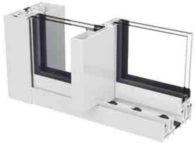
**ACRISTALAMIENTO:** Se efectúa mediante juntas de EPDM de cuña con vidrio alojado entre ellas. Los espesores de acristalamiento posibles van desde el mínimo de 18 mm a un máximo de 38 mm de espesor total del elemento.
