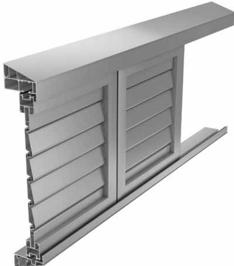
medidas **entre los 150 y 400 mm**, que pueden ser colocadas en horizontal o vertical según las necesidades del proyecto. Por último, existe la posibilidad de instalarlas de manera fija o móvil, pudiendo orientarse de manera manual o mecánica. En este último caso puede hacerse uso de la domótica, vinculando su movimiento a la gestión lumínica o térmica del edificio.
