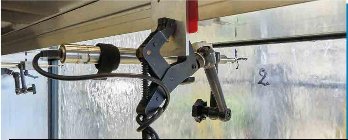
*Durante el ensayo de resistencia al viento, un sensor mide el grado de deformación de la fachada durante la prueba. La muestra testada puede soportar una presión alterna positiva y negativa de 2.500 Pa con una carga de seguridad de 3.750 Pa. Derechos de imagen: Christian Eblenkamp*
