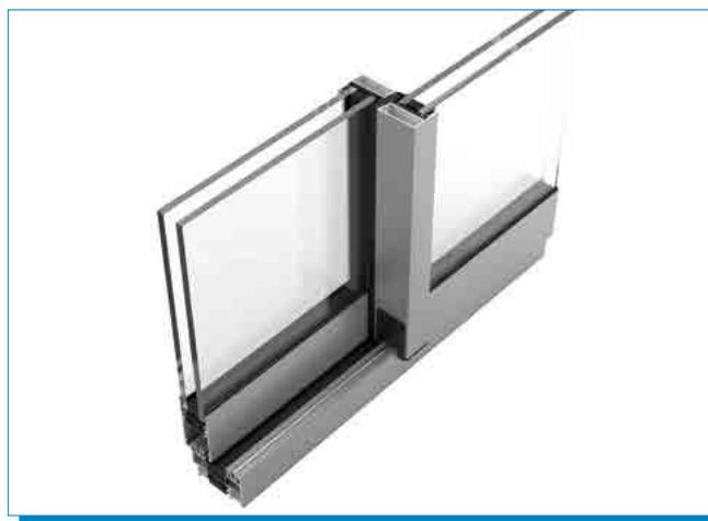
acristalamiento de hasta **32 mm**, la gran funcionalidad de la serie **S-LIM** se sustenta en los rodamientos, que permiten el suave deslizamiento de **hojas que pueden alcanzar los 300 kg**, y en el cierre, el cual ofrece dos posibilidades (embutido o multipunto con opción de microventilación). Asimismo, facilita composiciones de múltiples hojas en marcos de 2, 3 y 4 carriles.
