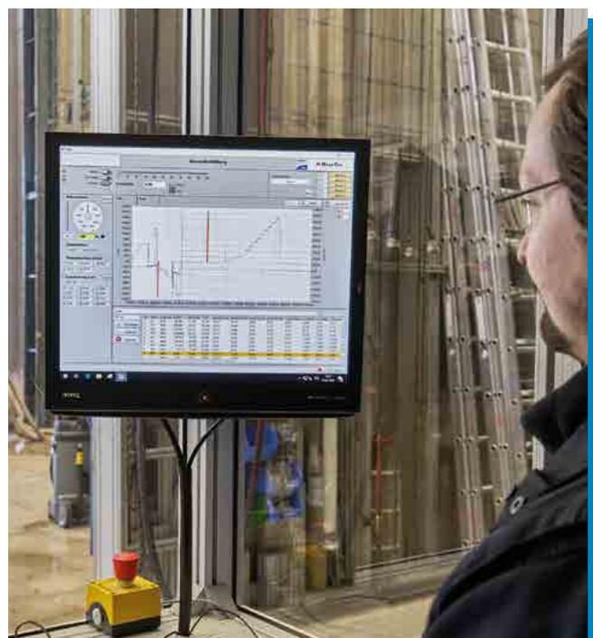
*El software se utiliza para registrar y controlar las fuerzas, como las cargas de viento y agua aplicadas a la fachada modular durante los ensayos, así como los resultados de la medición. Derechos de imagen: Christian Eblenkamp*
