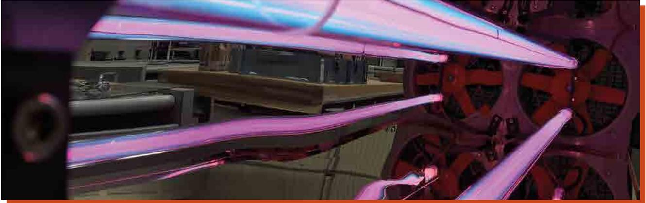
Con el reinicio de la actividad presencial el pasado mes de abril, Barberán ha diseñado un equipo de desinfección del aire por radiación ultravioleta, como medida de seguridad para sus trabajadores. Un dispositivo eficaz, sin generación de ozono, respetuoso con el medio ambiente, capaz de eliminar microorganismos como virus (COVID-19), bacterias (E-Coli), levaduras y hongos en segundos.
