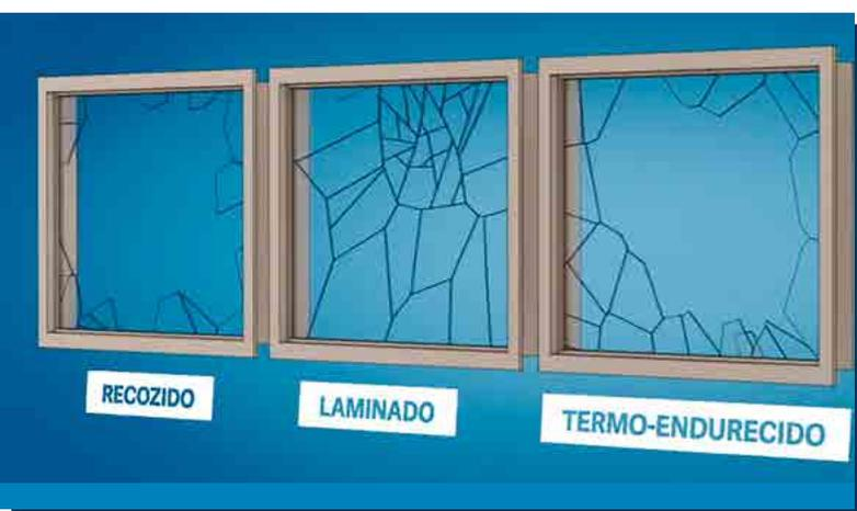
La resistencia a la flexión de un vidrio monolítico es superior a la de un vidrio laminado de igual espesor total. La ventaja de este segundo vidrio es que, aunque rompa, el intercalario (PVB) mantiene unidos los fragmentos, lo que aporta seguridad. De hecho, el vidrio Guardian LamiGass cumple con normativas europeas, o como dice el Código Técnico de la Edificación (CTE).
