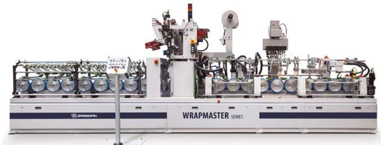
Barberán apuesta por el recubrimiento de perfiles de aluminio y pvc con una **nueva recubridora**, para el encolado de folios de papel o pvc **con adhesivo termofusible PUR sobre perfiles de aluminio** y pvc.
