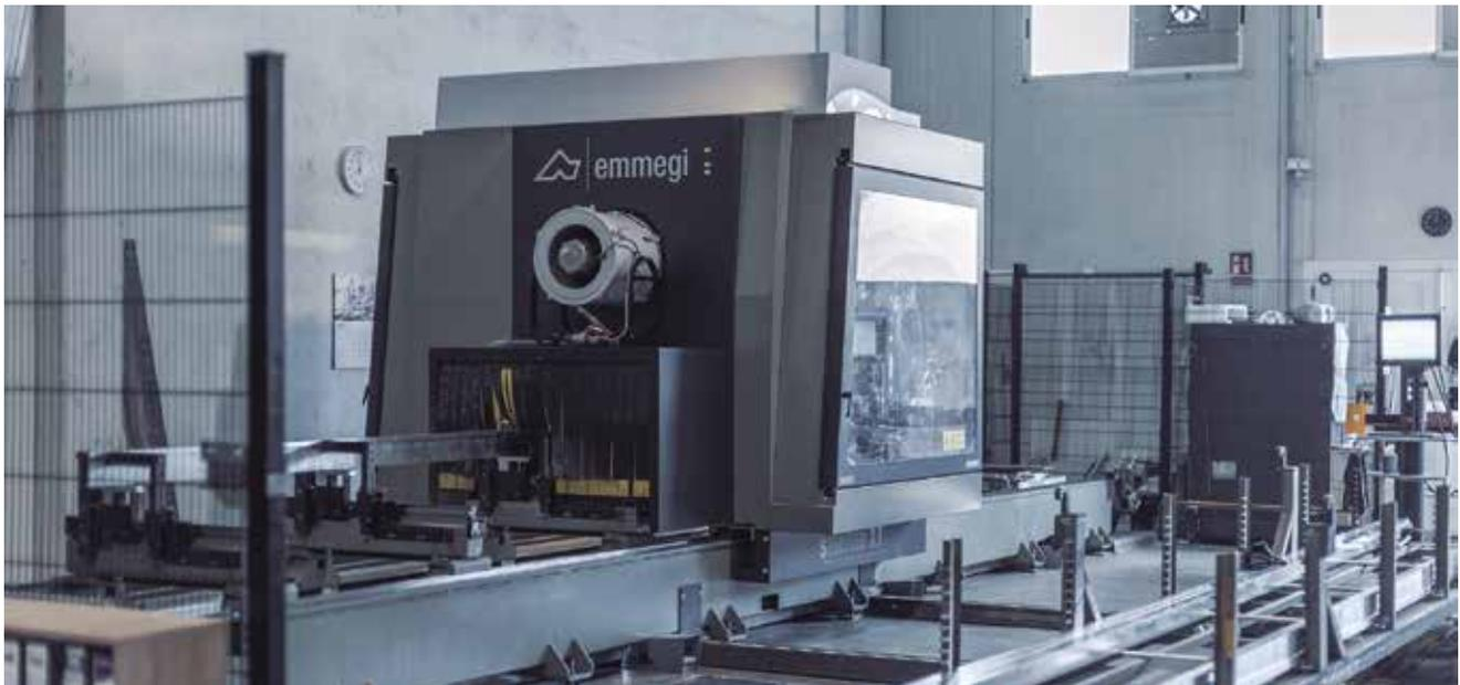
Centro de trabajo de 5 ejes con control numérico y puente móvil. Sirve para fresar, taladrar, roscar y cortar barras o piezas de aluminio de grandes dimensiones, pvc, aleaciones ligeras en general y acero.
