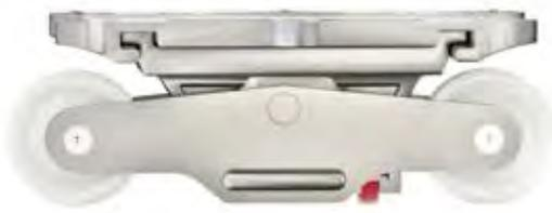
Las unidades de presión PSL realizan el ajuste entre la hoja y el marco permitiendo un ajuste tridimensional de los mismos. La presión de las juntas de goma se puede ajustar a la situación de instalación en obra a través de los bulones de cierre de la hoja.
