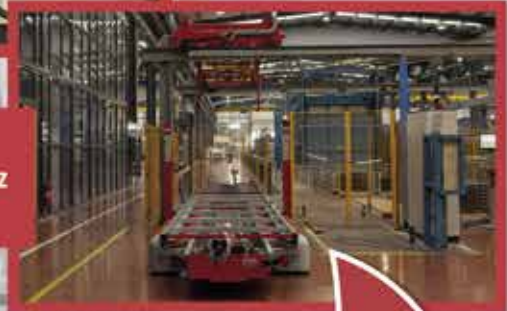
ALBATROS Sistema logístico aéreo en interfaz con almacén automático y AGVs
