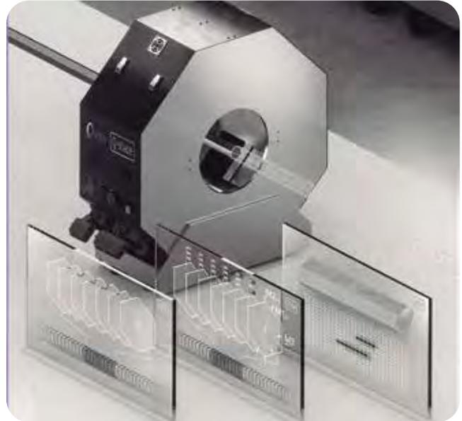
Con ALTEXPO se mostró el **nuevo concept ALTEX Q<sup>A</sup>SHAPE** que permite verificar, catalogar e intercambiar datos con parámetros dimensionales, tolerancias y torsiones, defectos superficiales y temperaturas de los perfiles extruidos **en línea durante el ciclo de extrusión**, a través de un concept que tiene como piedra angular el uso de los dispositivos especiales láser de múltiples longitudes de onda.
