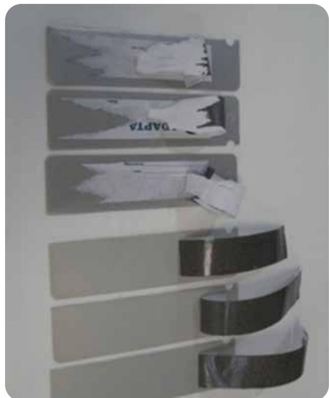
Aspecto de las superficies separadas tras el ensayo de pelado a 90° en condiciones ambientales de laboratorio (Temperatura: 23+2°C y Humedad relativa: 50+5%).
