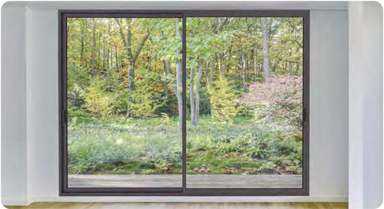
Cortizo amplía las posibilidades de su sistema 4700 Corredera, incorporando una nueva versión con herraje elevable que facilita el deslizamiento suave de hojas de hasta 300 kg de peso. Esta serie sustituirá a la 4500 Corredera Elevable, mejorando su eficiencia energética y ofreciendo una fabricación más rápida con montaje de junquillos a corte recto sin necesidad de grapas.
