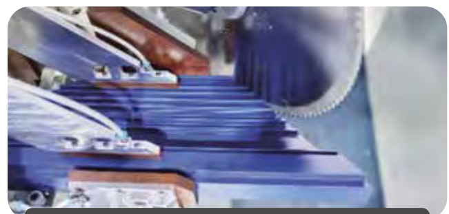
Pinzas verticales y horizontales con servoaccionamiento
