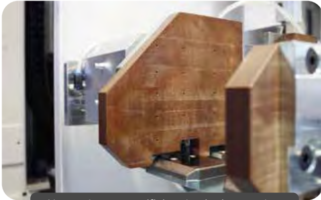
Abrazadera con orificios de aire integrados.
