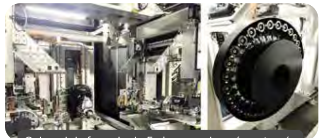
Cabezal de fresado de 5 ejes con almacén automático de herramientas de 30 posiciones
