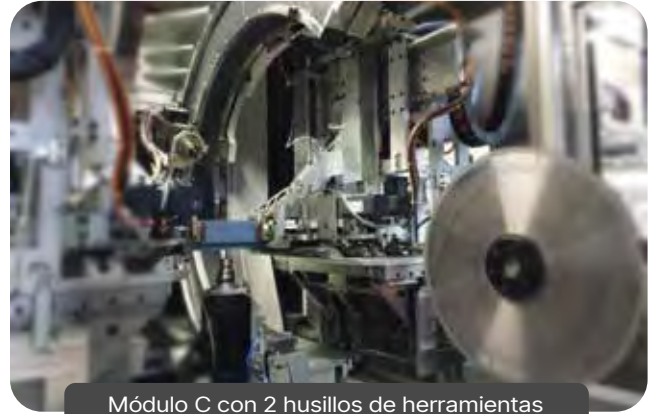
Módulo C con 2 husillos de herramientas
