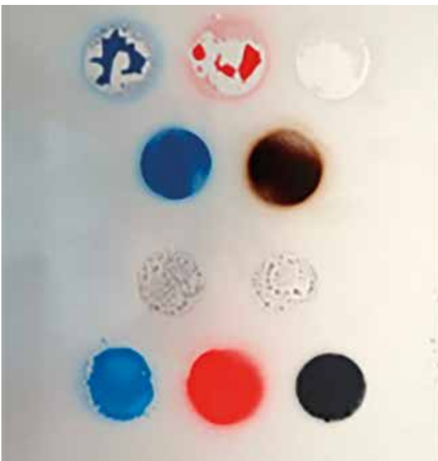
Figura 4: La misma hoja de prueba pintada con ADAPTA Antigraffiti HCR antes y después de la prueba de eliminación de 10 tintes diferentes.
