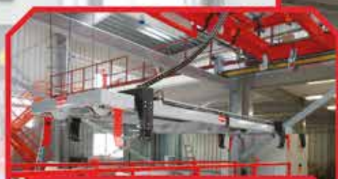
puente grúa apilador en interfaz con almacén automático.
