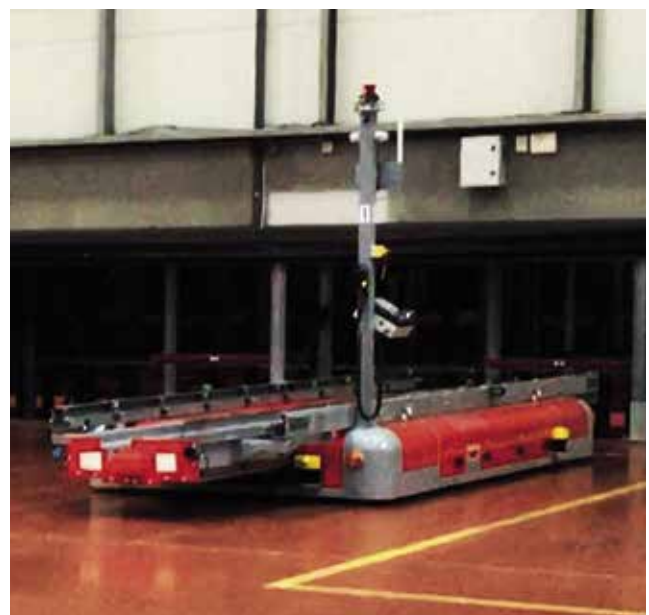
Interfaz de vehículo AGV con almacén automático
